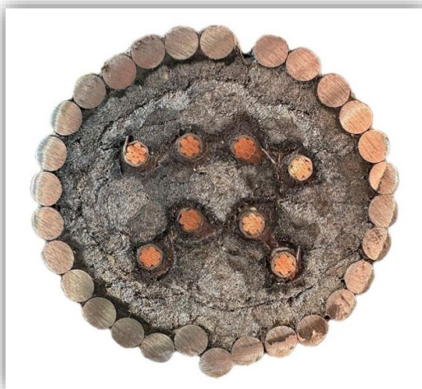
Przekrój magistralnego kabla fortecznego o izolacji gutaperkowej chronionego zewnętrznym pancerzem z drutów stalowych. Fot. Mariusz Kisiel.
