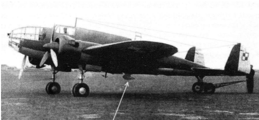
Samolot PZL-37 Łoś z widoczną pod kadłubem anteną radionamiernika W2L/N
