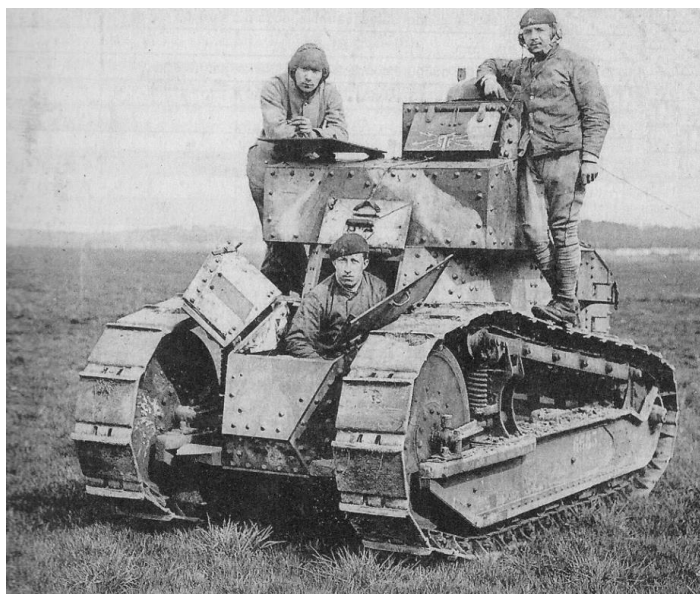
Renault TSF z radiostacją E 10 ter
