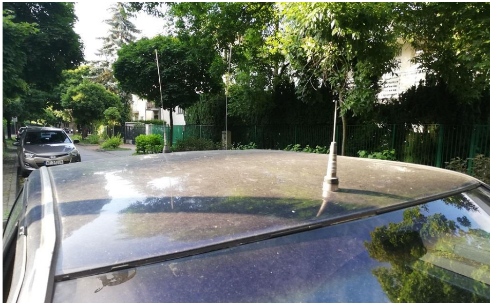
Typowe rozmieszczenie anten na samochodzie operacyjnym – na pierwszym planie antena Ericson EDACS, na drugim – antena Radmor do radiotelefonu analogowego
