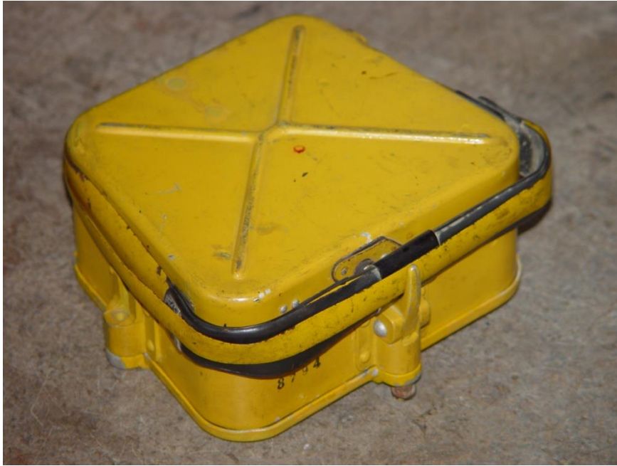
Nadajnik NS-4 z widoczną „nawiniętą” anteną taśmową
