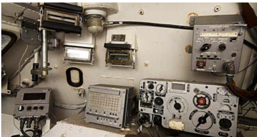
Stanowisko dowódcy wozu PU-12 (od lewej: blok synchronizacji, tablica informacyjna IT-1, radiostacja R-123M i pulpit łączności wewnętrznej PWS-2)
