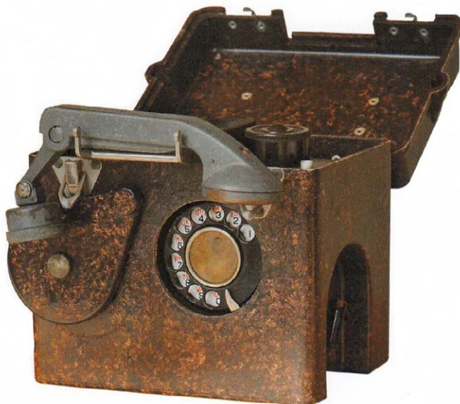
Telefon polowy TM 1939 z wbudowaną tarczą numerową
