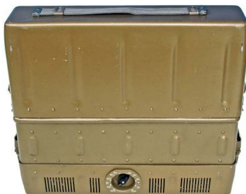
Radiostacja R-353L w wersji A (w dolnej części widoczny zasilacz sieciowy)
