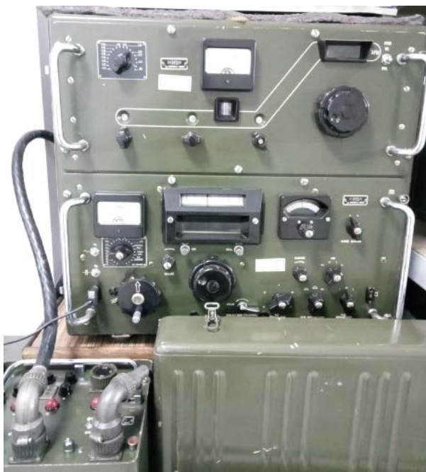
Odbiornik R-1250 wraz z zasilaczem sieciowym
