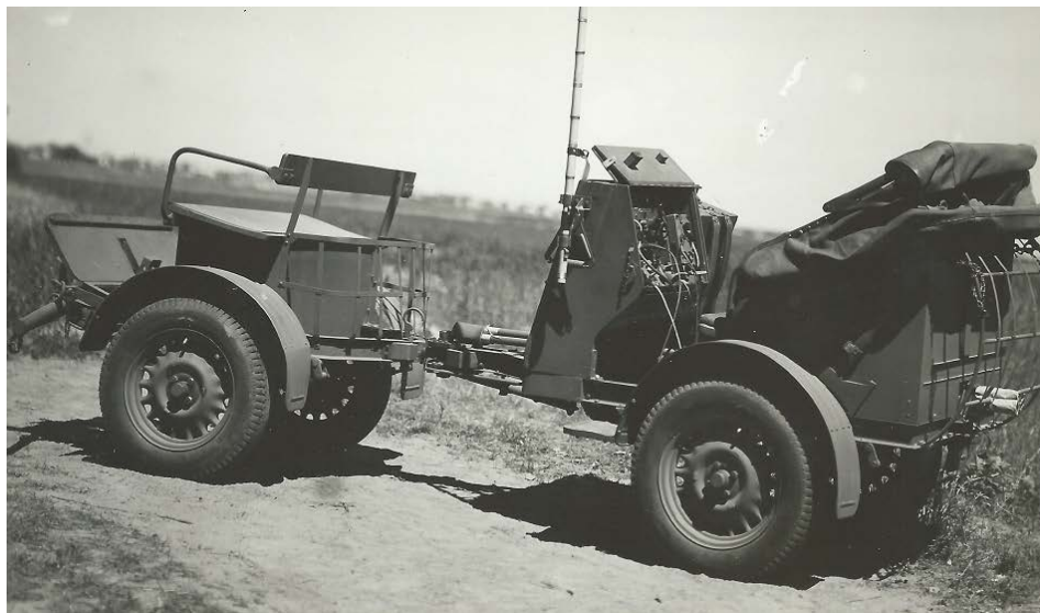
Taczanka z radiostacją N2/T
