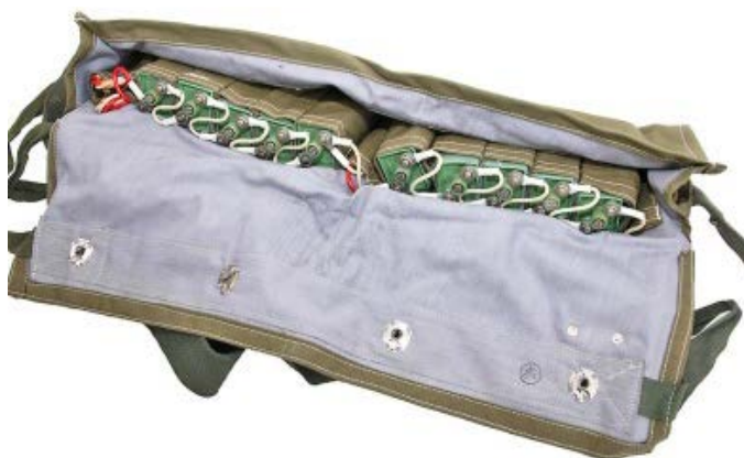
Pas z akumulatorami do zasilania radiostacji (10 x 1,2V)
