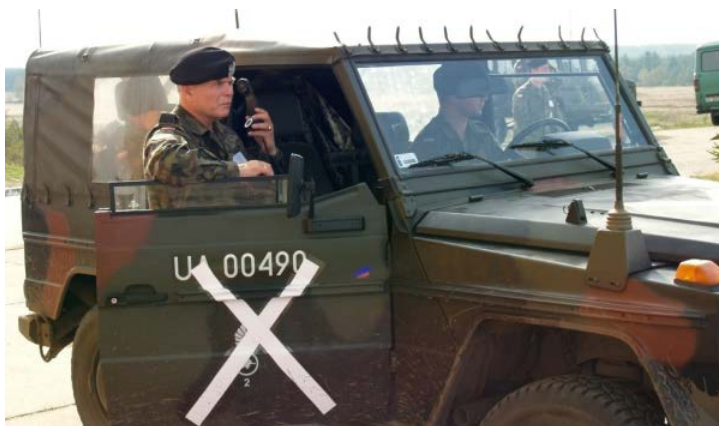
Wóz dowodzenia WOLF Fu 2 (widoczne dwie anteny – jedna z przodu i jedna z tyłu)
