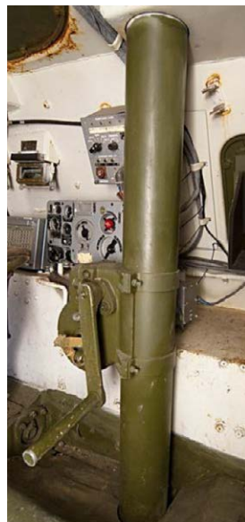
Mechanizm podnoszenia masztu teleskopowego
