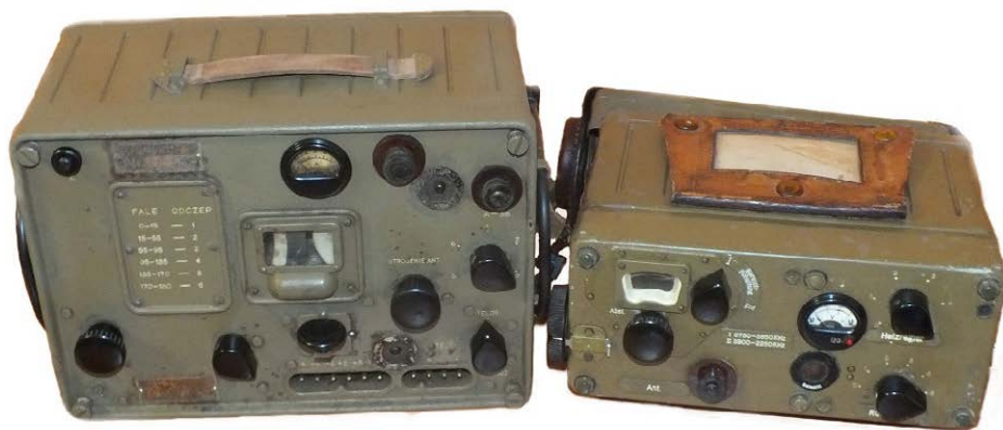
Radiostacja N2 (z lewej strony nadajnik)
