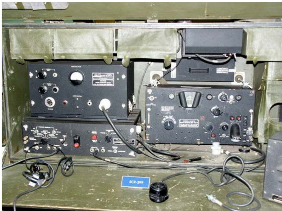
Wnętrze radiostacji SCR-399
