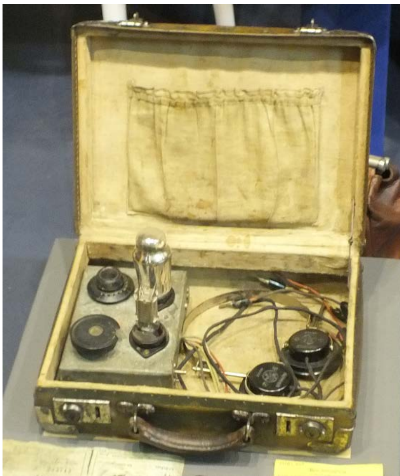
Odbiornik radiowy zamontowany w walizce
