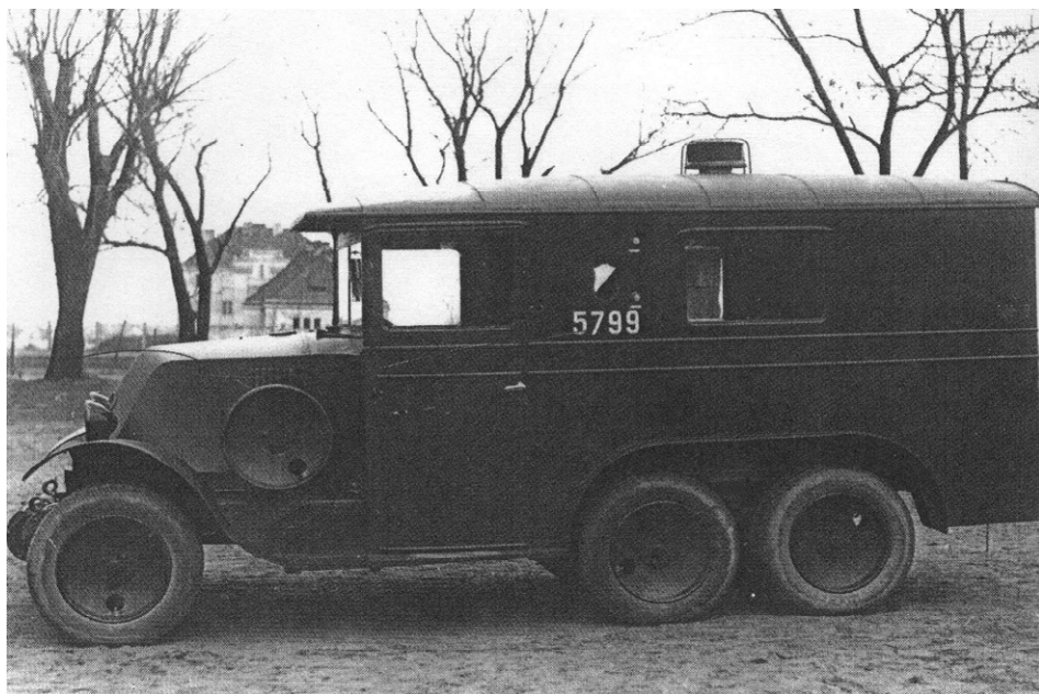
Radiostacja RKG/A na samochodzie Renault MH2
