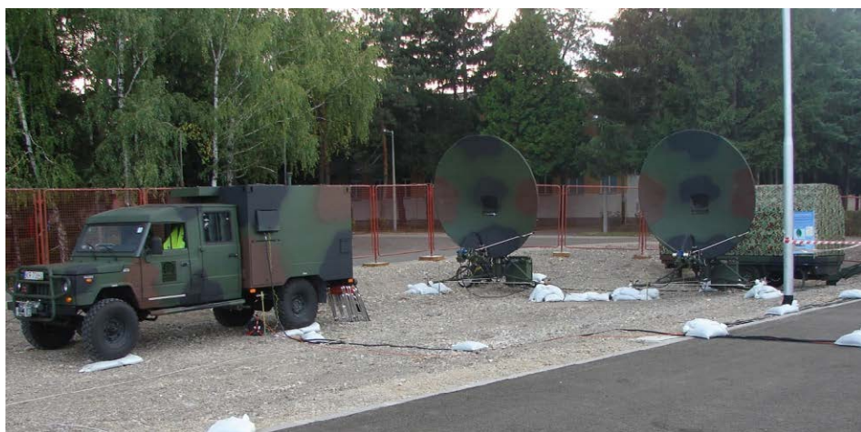
Rozwinięta radiolinia troposferyczna MAT – 10HT podczas ćwiczeń NATO CE 09 w Bośni (fot. ZDZ Kraków)
