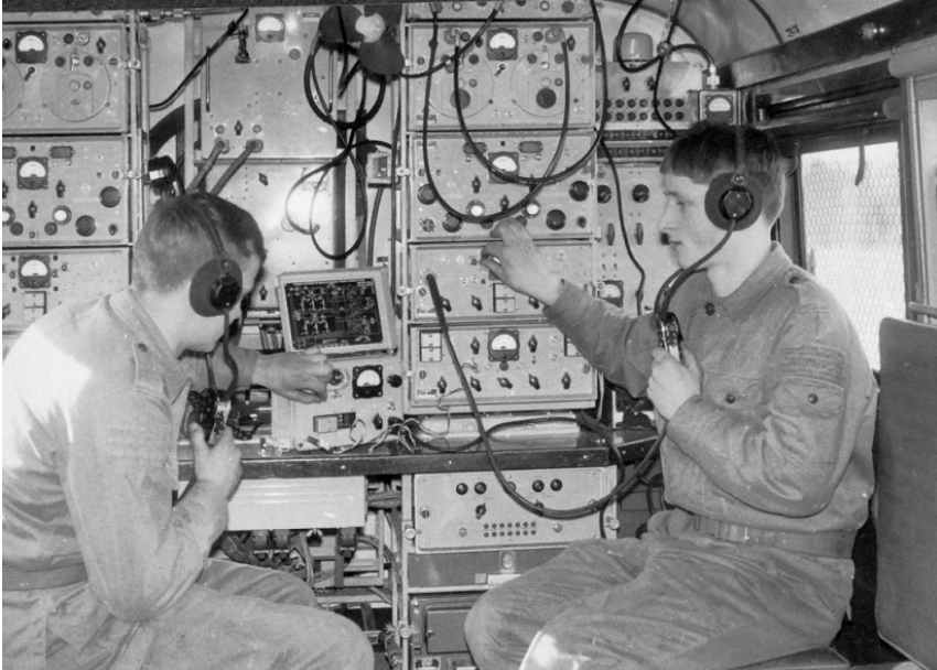
Wnętrze stacji radioliniowej R-405-Z
