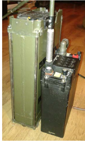
Porównanie gabarytów radiostacji – z lewej Tuberoza T-2/O1, z prawej Tuberoza 1 (radiostacje bez akumulatorów)
