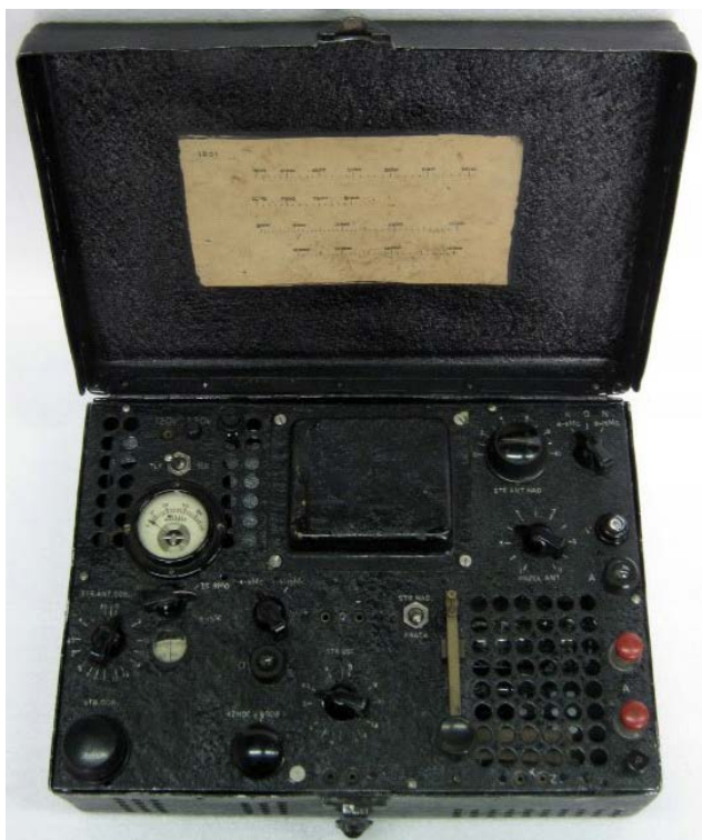
Radiostacja zrzućowa B2
