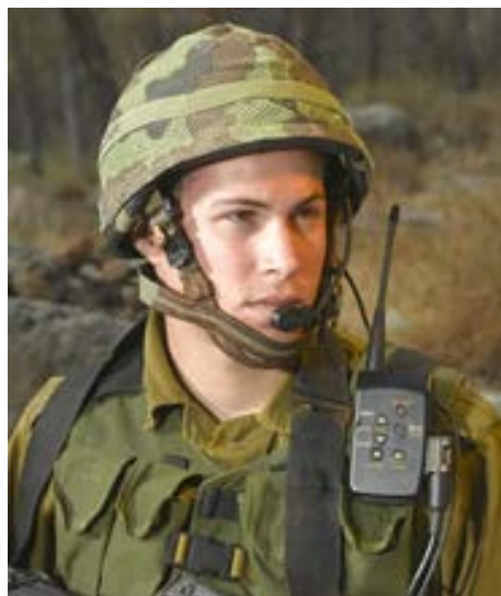
Radiostacja PNR-500 w pozycji roboczej
