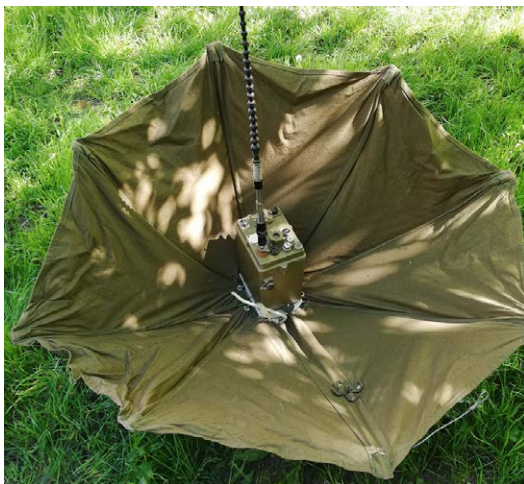
Nadajnik R-128M w „parasolu” stabilizującym
