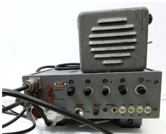
Odbiornik R-872 wraz z głośnikiem wynośnym GR
