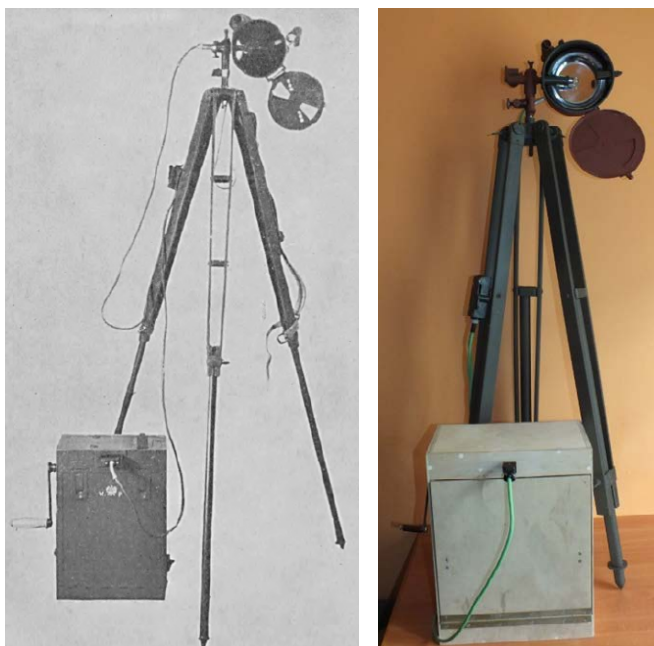
Aparat sygnalizacji świetlnej ASS-31/33 (z prawej replika ASS-31 wykonana wspólnie przez członków o/Zegrze ŚPŻŁ i Stowarzyszenia Historycznego im. 10 p.p. z Łowicza)
