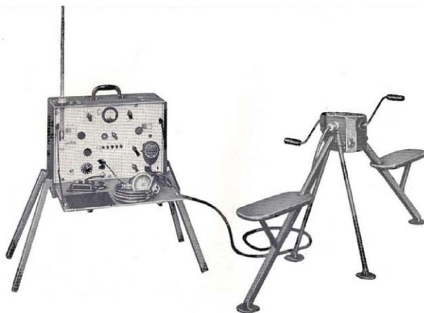
Radiostacja V-100-B z ręcznym generatorem prądu
