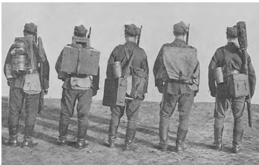
Radiostacja RKD w wersji plecakowej
