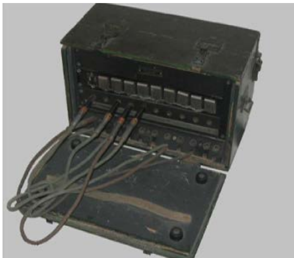
Łącznica ŁP-10 w drewnianej obudowie
