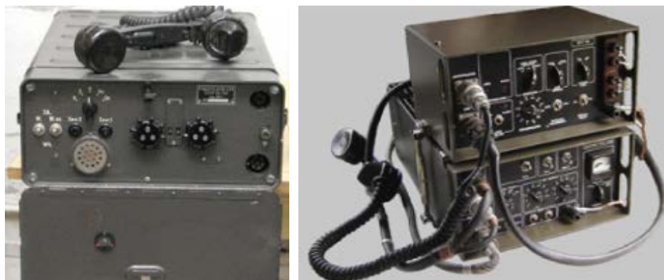
Z lewej radiotelefon K-1, z prawej K-1M z blokiem rozwidlenia
