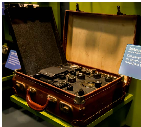
Radiostacja MR 3 zabudowana w walizce podróźnej
