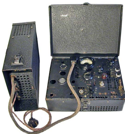
Radiostacja BP4 w wersji jako nadajnik, po lewej zasilacz sieciowy
