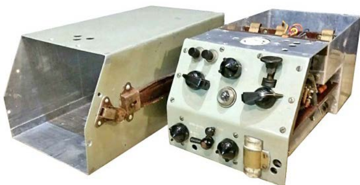
Radiostacja AT/1 wyjęta z obudowy
