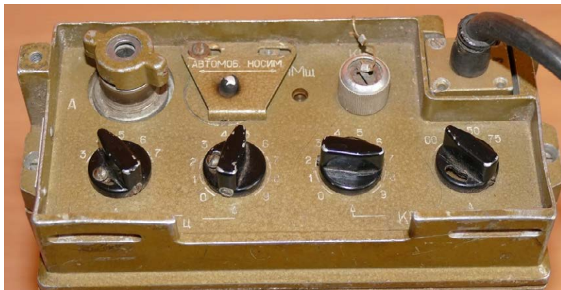
Płyta czołowa radiostacji R-158
