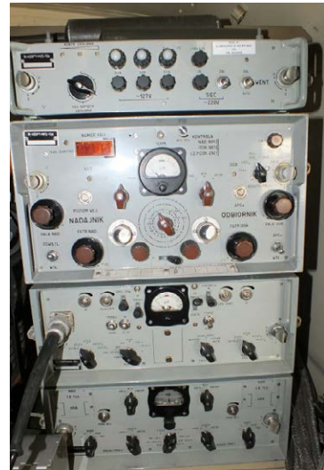
Półkomplet radiolinii R-405PT-M/S-1Sz wewnątrz radiostacji R-140M
