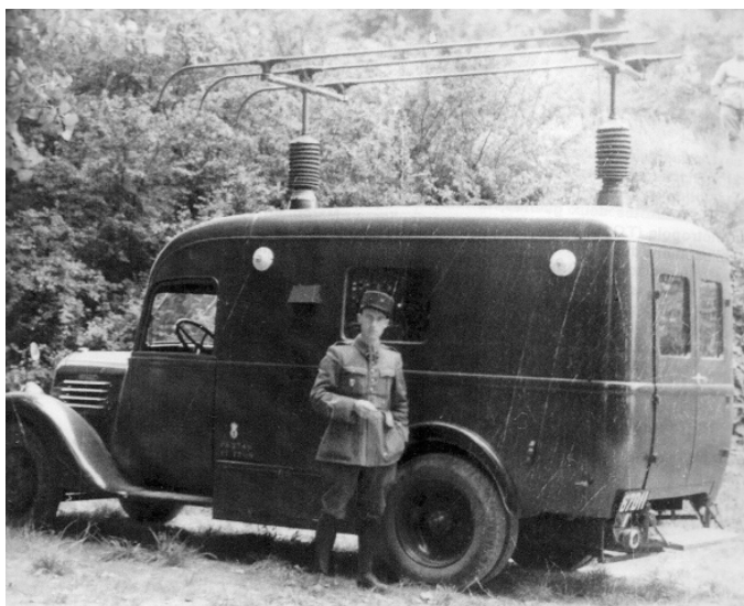
Radiostacja ER 27 mod. 1935 na podwoziu Renault
