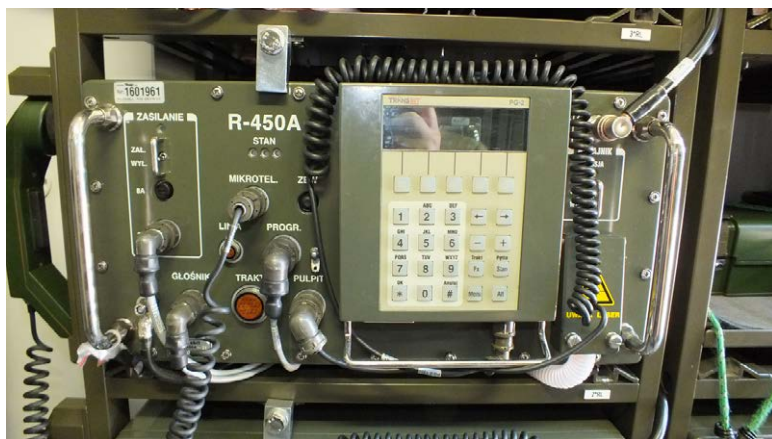
Radiolinia R-450A zamontowana w aparatuwni RWŁC-10/T
