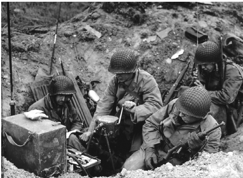
Radiostacja SCR-284 zasilana z ręcznego generatora prądu
