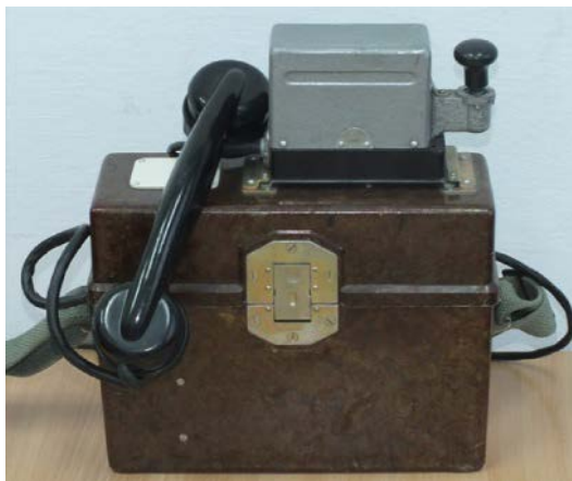
Telefon polowy TAI-43MR z zamontowanym kluczem telegraficznym
