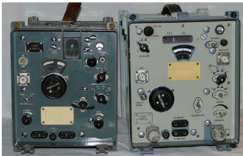
Z lewej odbiornik R-326, z prawej R-326M
