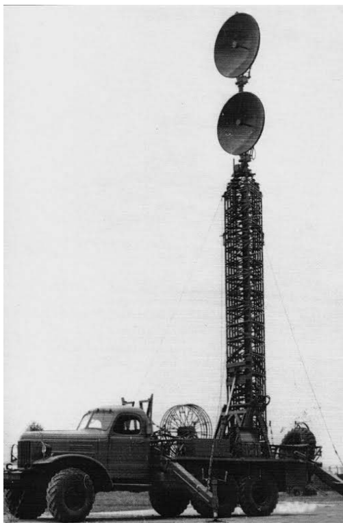
Radiolinia R-400. Z lewej – wóz antenowy, z prawej stojak aparatury
