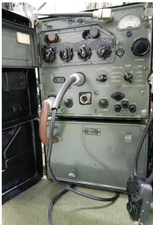
Radiostacja R-809 z blokiem zasilania baterijnego
