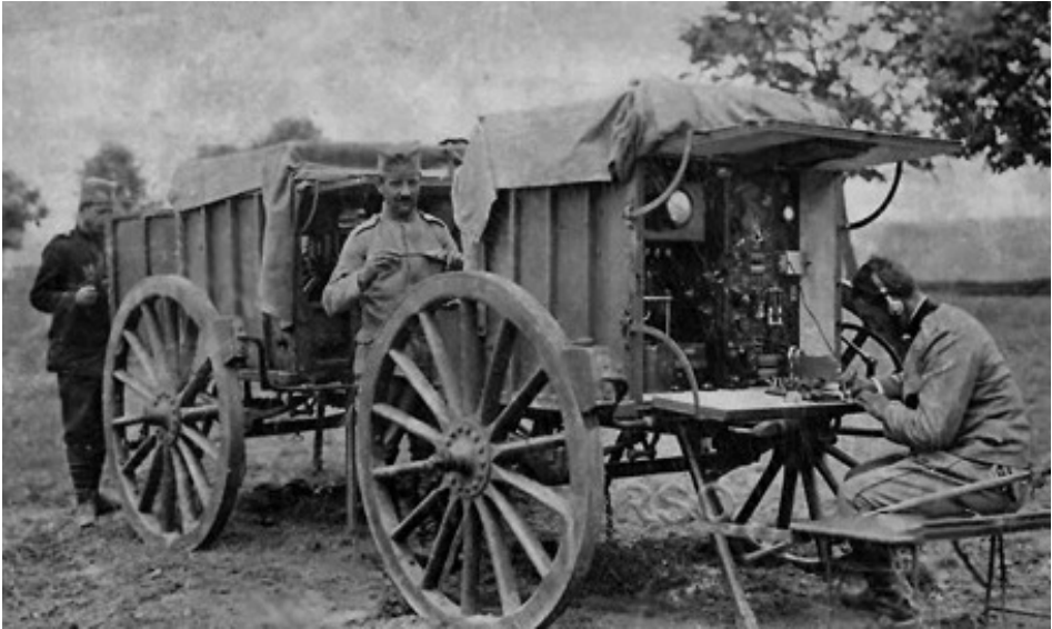
Radiostacja Marconiego o mocy 1,5 kW przystosowana do zaprzęgów konnych
