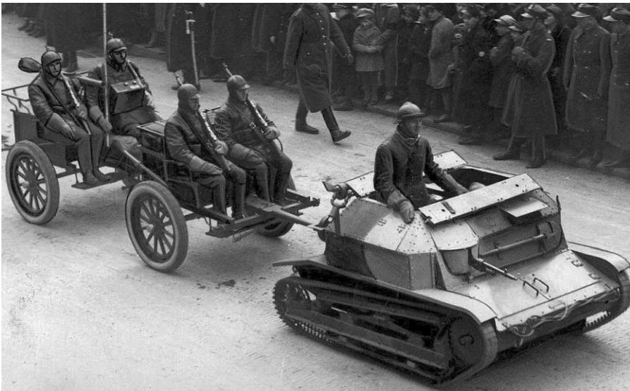
Radiostacja RKD ciągniona przez tankietkę TK-3
