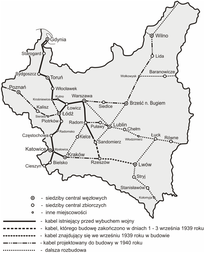
Sieć kabli telefonicznych dalekosiężnych
