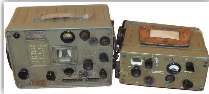
Radiostacja N2 (z lewej strony nadajnik)
