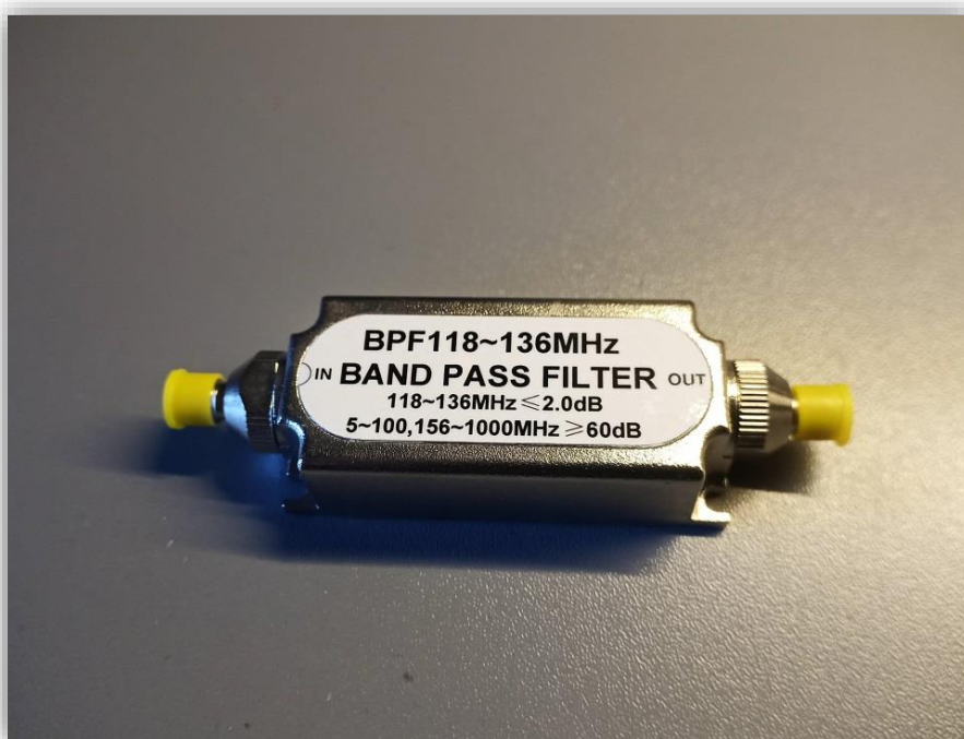
Filtr pasmowo przepustowy
