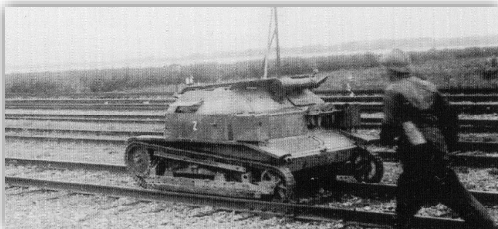
Tankietka TK-3 z radiostacją RKB po zejściu z prowadnicy
