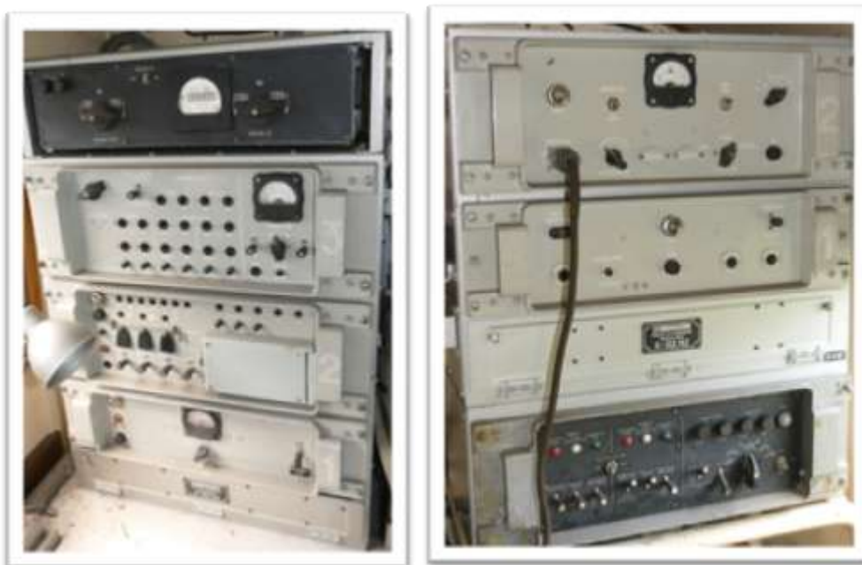
Wnętrze wozu odbiorczego radiostacji R-102 MZ, od lewej Pulpit starszego radiooperatora, pulpit dyżurnego operatora
