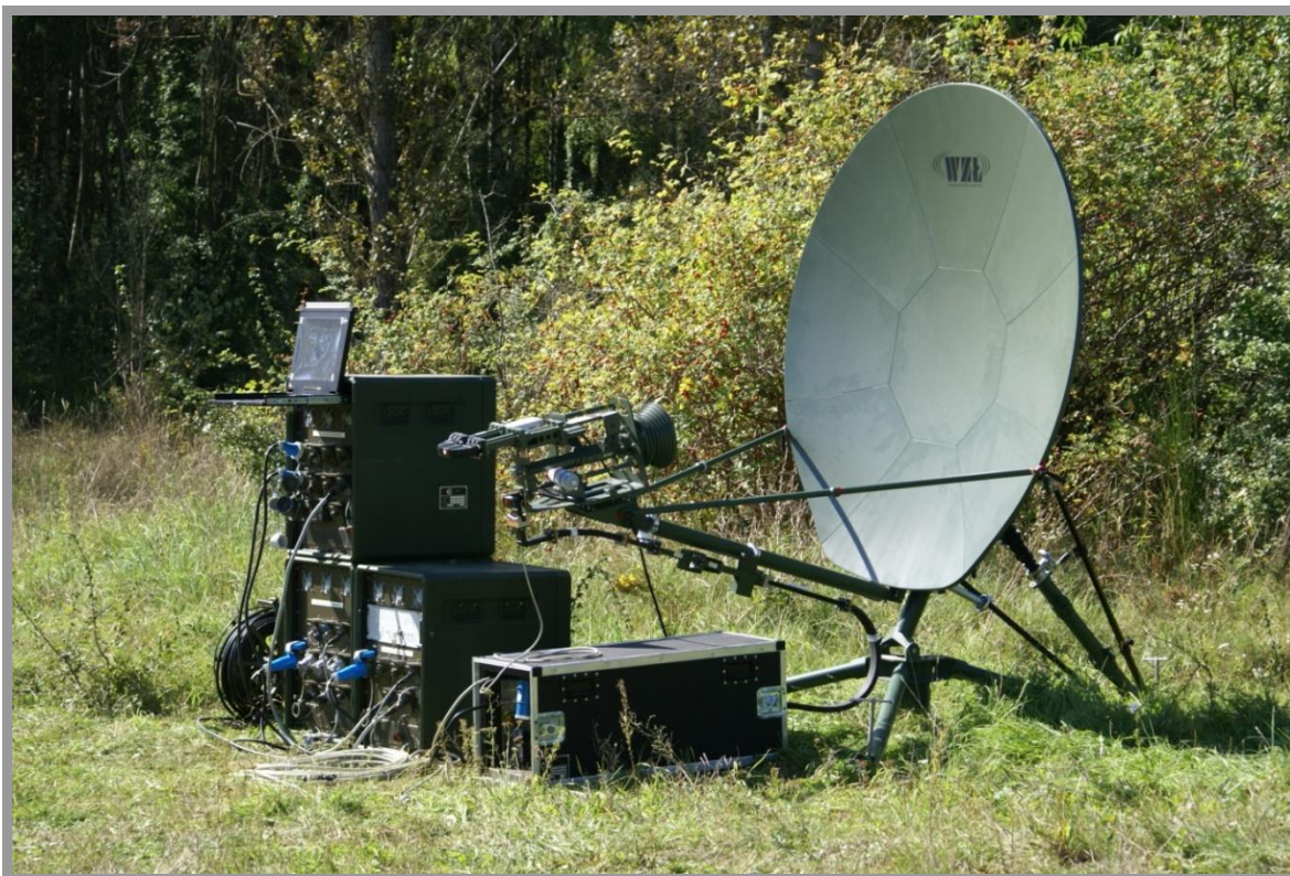
Przewoźno – Przenośny terminal Satelitarny – PPTS 1,8v2 (poziom taktyczny i operacyjny).
