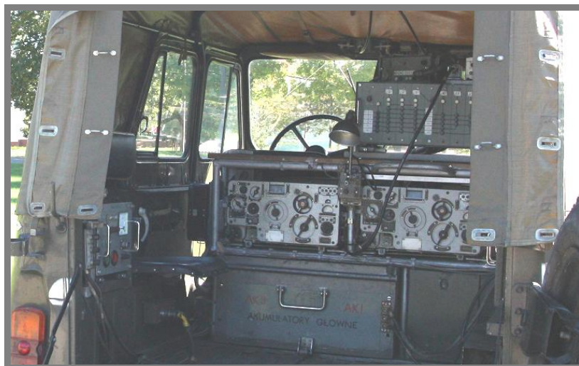
Wnętrze wozu dowodzenia WD-43
