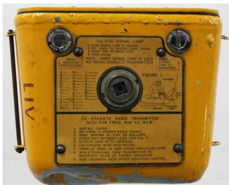
Górna część nadajnika z instrukcją obsługi nadajnika oraz lampy sygnalizacyjnej. Na zdjęciu widoczne gniazdo korby oraz kontrolka obrotów (po lewej) i kontrolka strojenia anteny (po prawej). (eksponat CSŁil)
