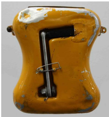
Tył nadajnika z korbą umieszczoną we wgłębieniu.
