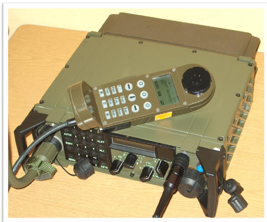
Radiostacja TRC 9200 /z mikrotelefonem wielofunkcyjnym/
