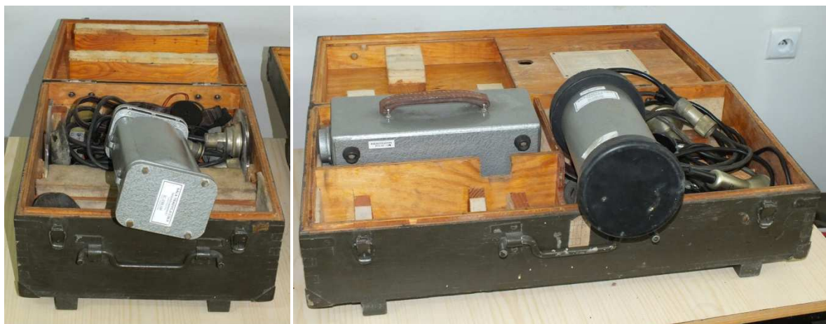
Radiotelefony podwodne RU-1 i RU-2 w skrzyniach transportowych
