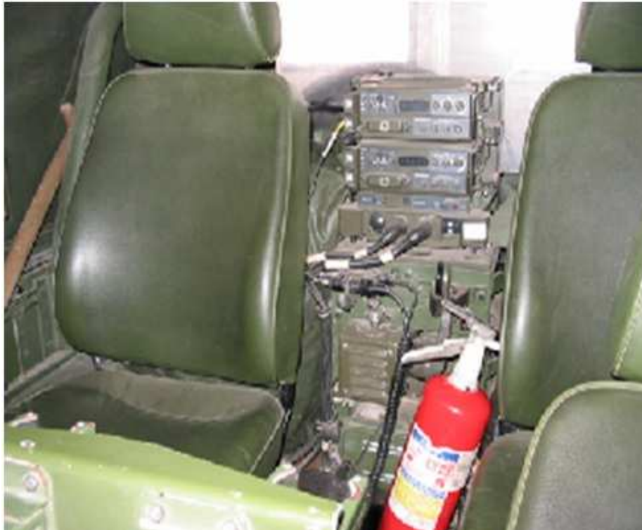
Wnętrze wozu dowodzenia WOLF - wersja z radiostacjami SEM 80/90
