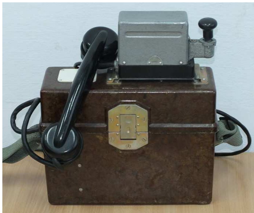
Telefon polowy TAJ-43MR z zamontowanym kluczem telegraficznym
