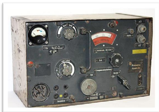
Radiostacja Fu 8 (z lewej odbiornik, z prawej nadajnik)
