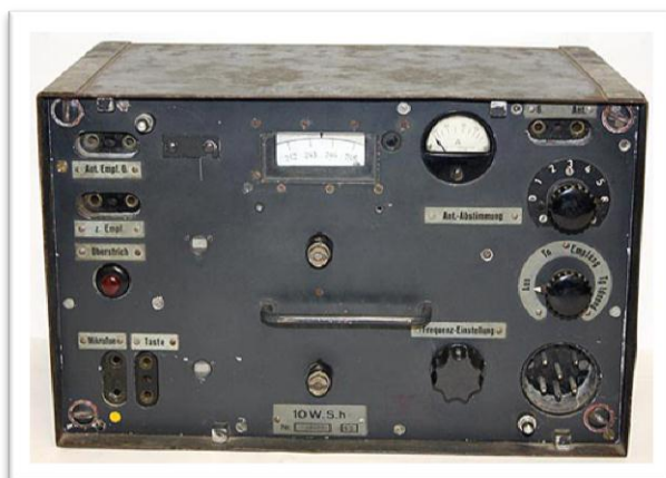
Radiostacja Fu 16 ( z lewej odbiornik, z prawej nadajnik)
