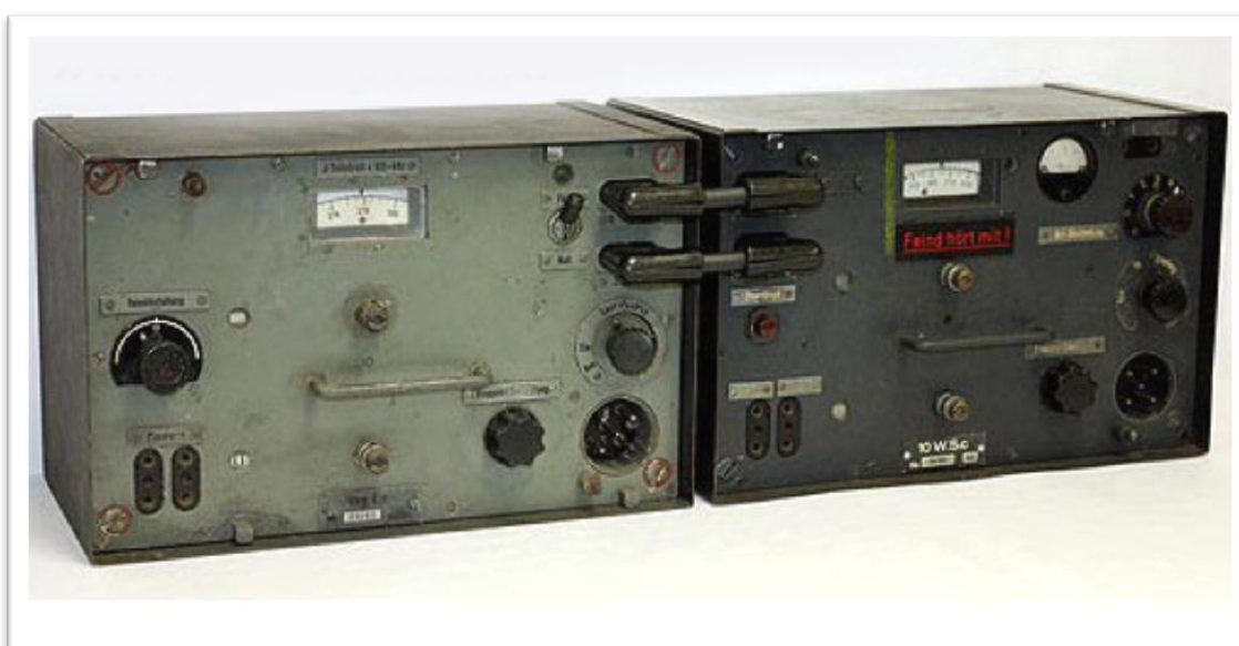
Radiostacja Fu 5 (z lewej odbiornik, z prawej nadajnik)
