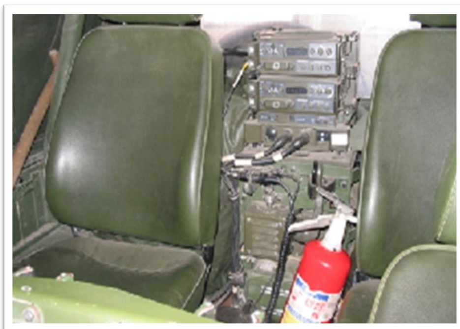
Wnętrze wozu dowodzenia WOLF - wersja z radiostacjami SEM 80/90
