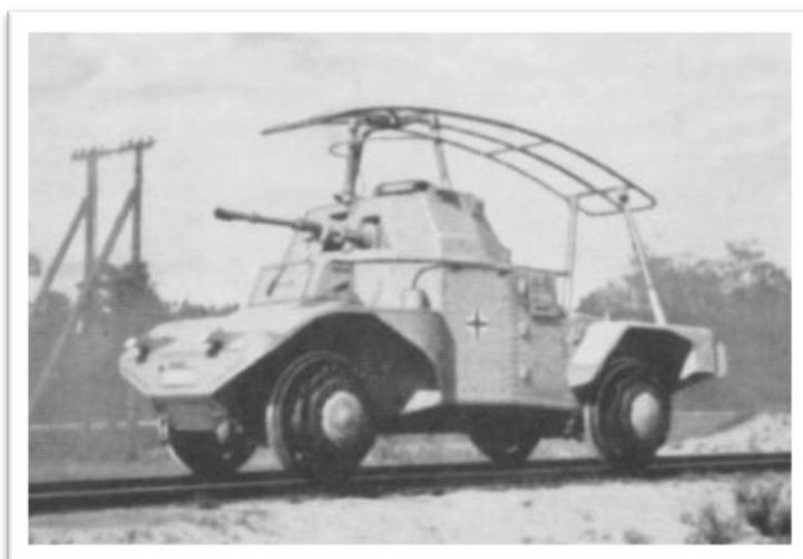
Sd.Kfz. 221 w wersji przystosowanej do jazdy po szynach, z lewej wnętrze (Fu 20)
