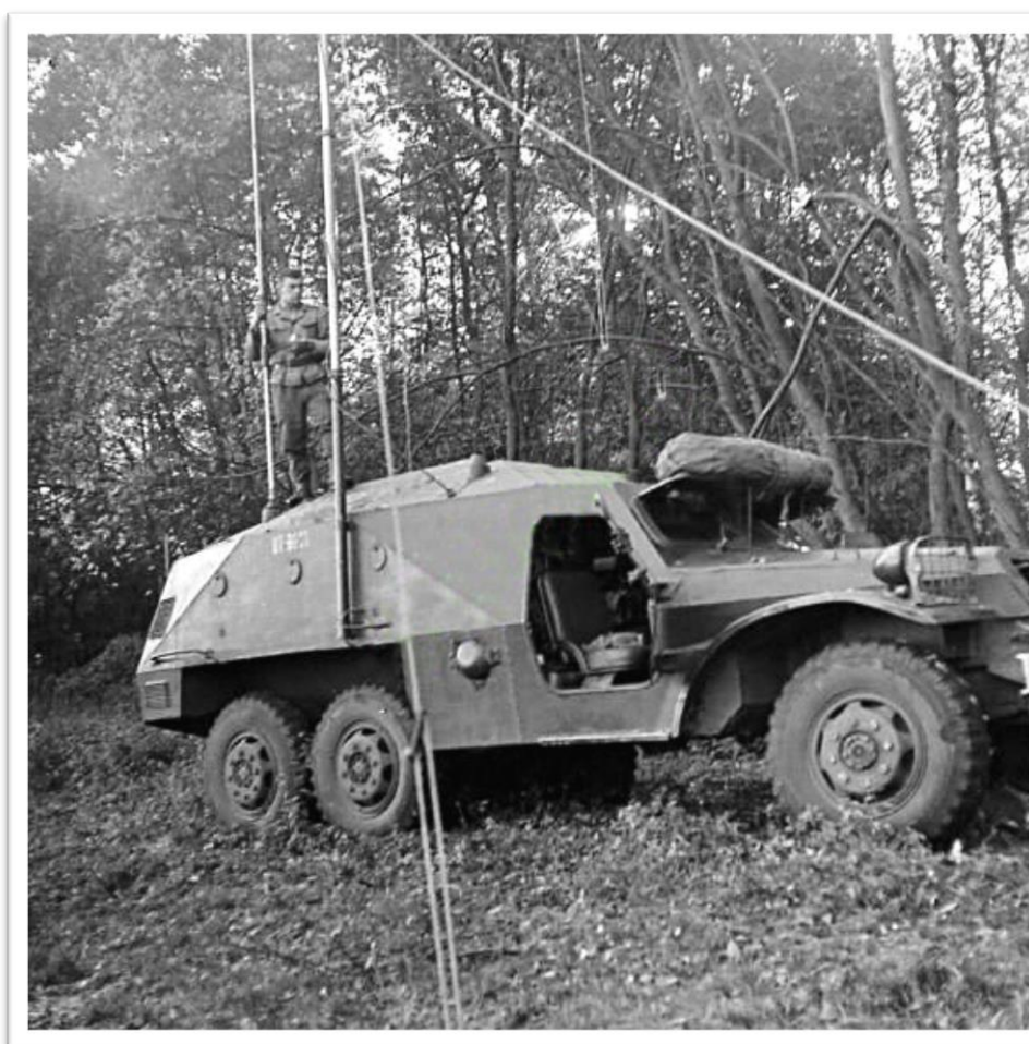
Radiostacja R-118 na transporterze opancerzonym BTR-152 /lata 50-te/
