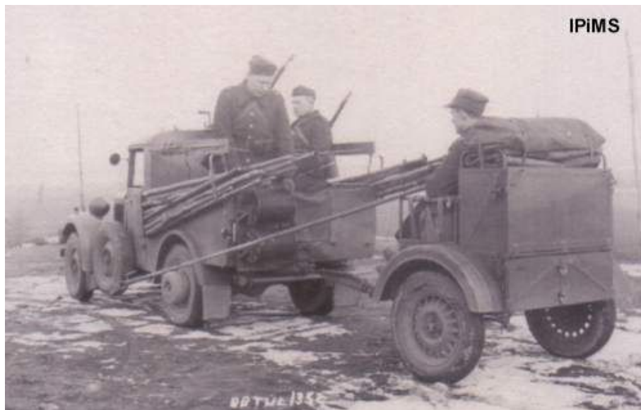
Telefoniści podczas rozwijania linii z samochodu Fiat 508/518 z przyczepą
