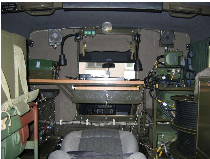
Radiostacja RF-5800H 400W
