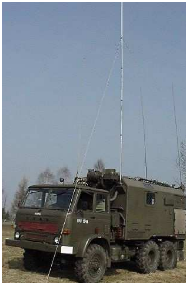
Radiostacja R-140M na samochodzie Star-266
