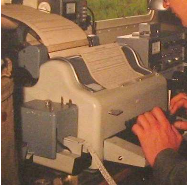
Dalekopis arkuszowy T-63 ( na zdjęciu wewnątrz radiostacji R-140M)
