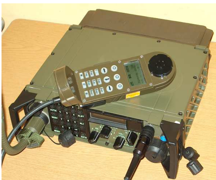
Radiostacja TRC 9200 /z mikrotelefonem wielofunkcyjnym/
