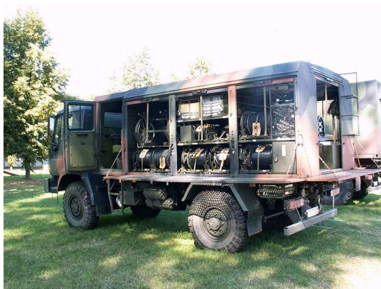
Węzłowy Wóz Kablowy WWK-10C
