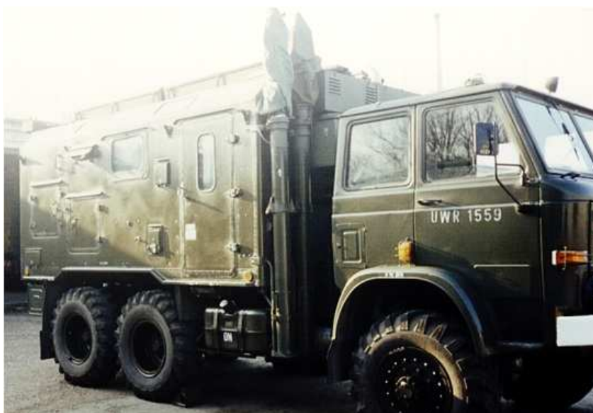
Radiostacja R-161AP na samochodzie Star-266
