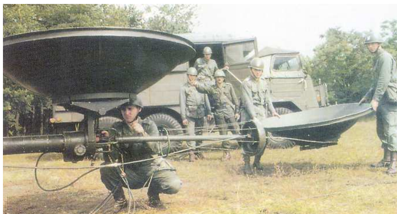
Montaż anten radiolinii R-404 (wersja na samochodach STAR-660)
