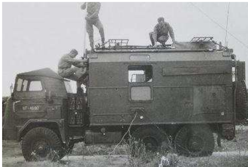
Radiostacja R-140 na samochodzie Star-660
