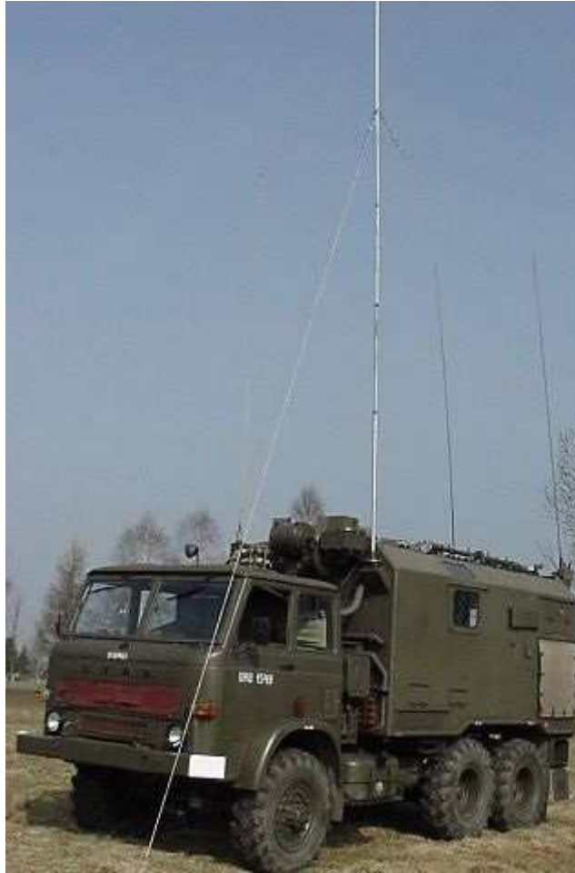
Radiostacja R-140M na samochodzie Star-266
