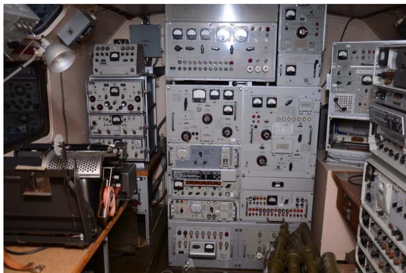
Wnętrze radiostacji R-140
