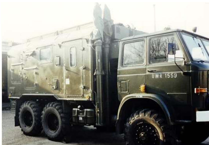
Radiostacja R-161AP na samochodzie Star-266
